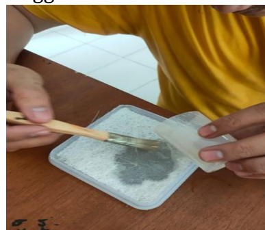
Gambar 22. Pembuatan Komposit Metode Hand Lay-Up
