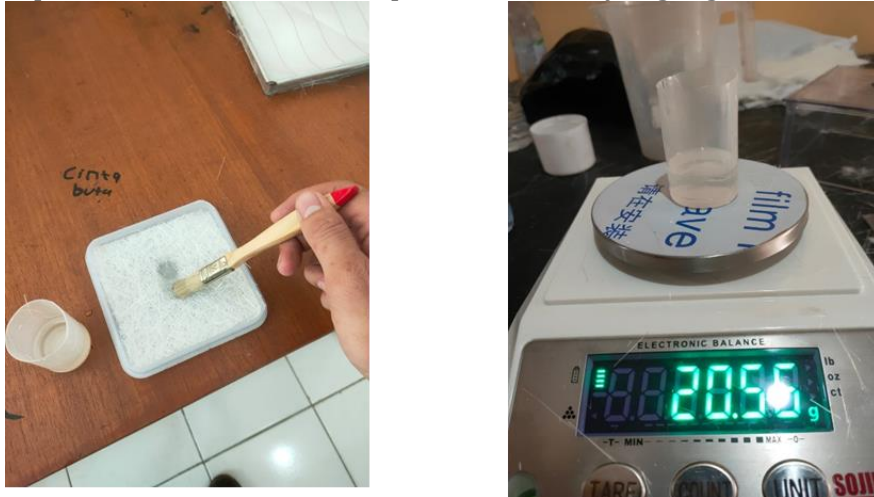
Gambar 11. Perbandingan Fiberglass Resin dan Katalis
