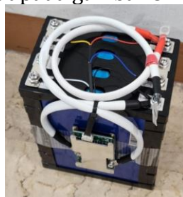
Gambar 8. Baterai Lifepo4 12V 100Ah
