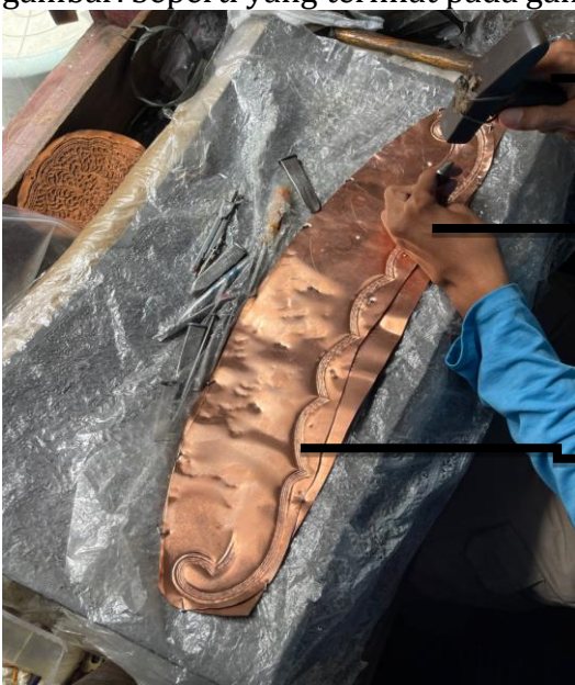
Gambar 4. Pemahatan Gambar pada Bahan Tembaga (Dokumen Pribadi, April 2023)
