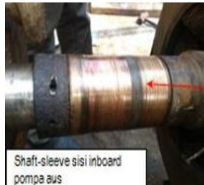
Gambar 7. Shaft Yang Sudah Aus
