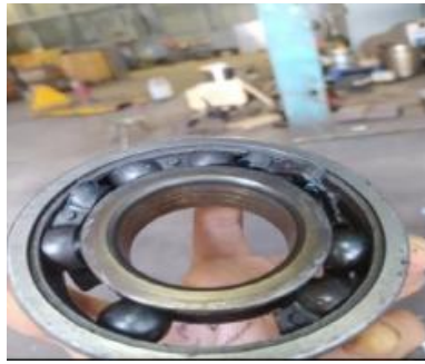
Gambar 6. Bearing Terjadi Korosi Dan Pecah
