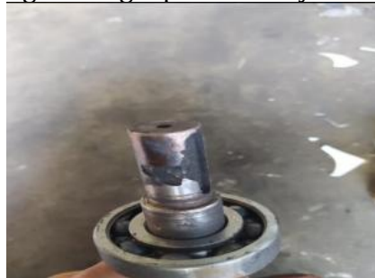
Gambar 5. Shaft Mengalami Korosi Dan Pecah
