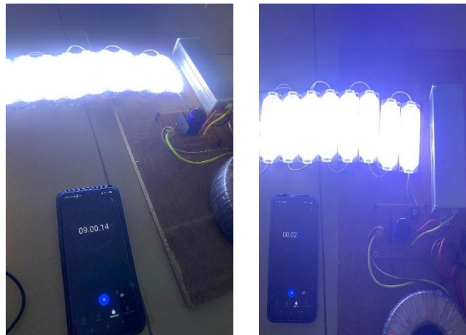
Gambar 2. Dokumentasi Pengujian Ketahanan Driver Power Supply Selama 9 Jam
