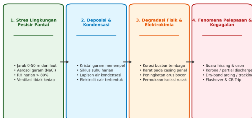
Gambar 2. Mekanisme Rantai Degradasi Isolasi dan Korosi Kubikel TM 20 kV di Lingkungan Maritim
