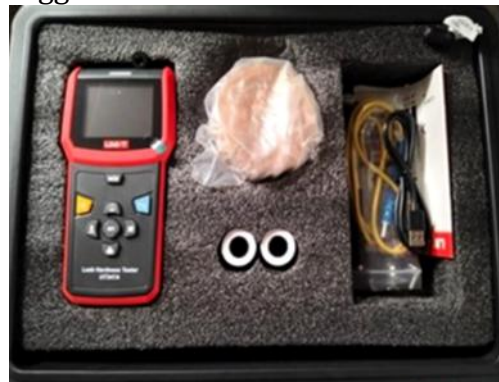
Gambar 1. Hardness Tester Untuk Pengukuran Kekerasan Spesimen
