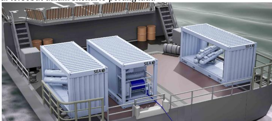
Gambar 9. Mission Module ASW The Cube dari SH Defence Sumber : (SH Defence, 2024)
